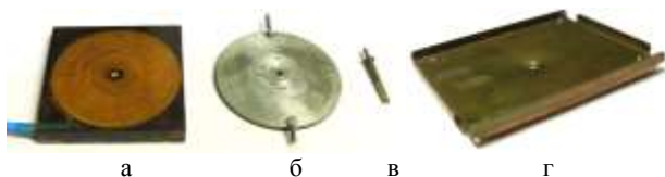
Рис. 2 – Элементы ИДД: а – индуктор; б – круглый якорь; в – боек; г – прямоугольный якорь
