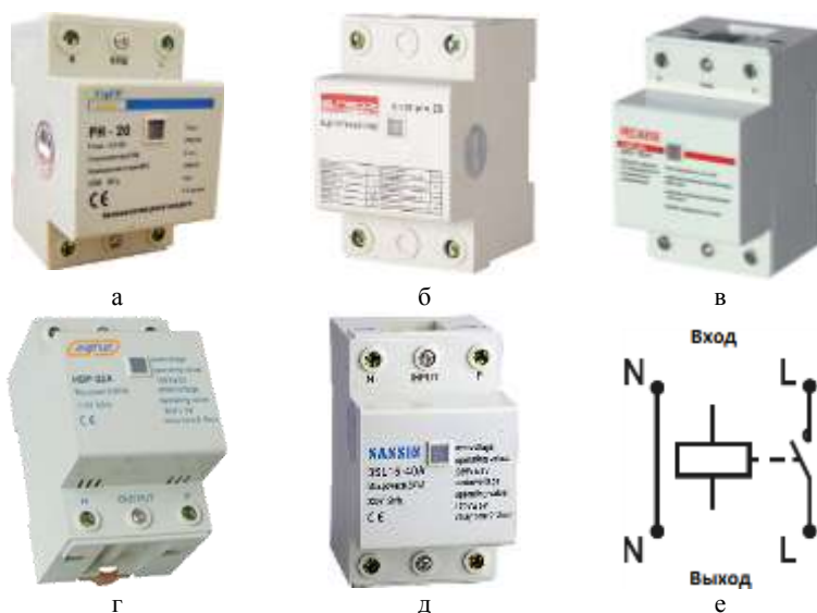
Рис. 1. Примеры конструктивных исполнений реле напряжения с двухцветной световой индикацией наличия напряжения на входе: а – серия PH [3] (АсКо-УКРЕМ, Украина), б – серия e.vrg.pro [4] (E-NEXT Украина), в – серия AZM [5] (Ресанта, Россия), г – серии Энергия HDP [6] (Энергия, Россия) и HDP [7] (MEBA Electric, Китай), д – серия 3SL15 [8] (Sassin International Electric, Китай); е – схема подключения реле.
