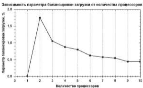
Рис. 6 – Зависимость балансировки загрузки от количества процессоров (типов процессоров – 2) для метода HDF RR (1000 заданий)
