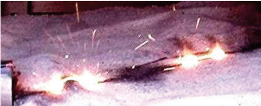
Рисунок 2 – Опытное распределение вдоль электротермически разрушенного оцинкованного стального провода ( $r_0 = 0,8$  мм;  $l_0 = 320$  мм;  $\Delta_0 = 5$  мкм) «горячих» (макроскопических зон ВЭП провода) и «холодных» продольных гантелеобразных участков, испытывающих воздействие апериодического импульса аксиального тока временной формы 9 мс/576 мс большой плотности ( $\delta_{0m} = 0,37$  кА/мм<sup>2</sup>;  $n_m = 32$ ;  $\bar{n} = 9$ ) [7]
