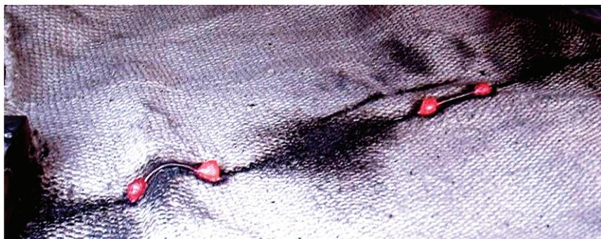
Рисунок 3 – Внешний вид остывающих «горячих» (бывших макроскопических зон ВЭП провода) и «холодных» продольных гантелеобразных участков электротермически разрушенного оцинкованного стального провода ( $r_0 = 0,8$  мм;  $l_0 = 320$  мм;  $\Delta_0 = 5$  мкм), по которому протекал аperiодический импульсный аксиальный ток временной формы 9 мс/576 мс большой плотности ( $\delta_{0m} = 0,37$  кА/мм<sup>2</sup>;  $n_m = 32$ ;  $\bar{n} = 9$ ) [7]
