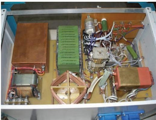
Рисунок 3 – ИГЛА-3В со снятой верхней крышкой
