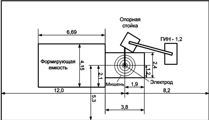
Рисунок 4 – План размещения элементов высоковольтного исследовательского
