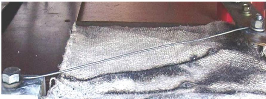
Рисунок 2 – Внешний вид исходного круглого оцинкованного стального провода ( $r_0 = 0,8$  мм;  $l_0 = 320$  мм;  $\Delta_0 = 5$  мкм;  $S_0 = 2,01$  мм<sup>2</sup>), размещенного в воздухе над теплозащитным асбестовым полотном, до протекания по нему в разрядной цепи высоковольтного генератора ГИТ-5С аперiodического импульса тока большой плотности [11]
