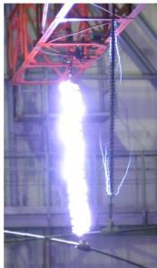
Рис. 7 – Перекрытие гирлянды стеклянных изоляторов при параллельном подключении гирлянды и макета удлинённого полимерного изолятора к источнику импульсного напряжения.
