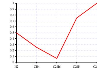
Рис. 6 – Графический образ дефекта в трансформаторе ПС «Бердянские жатки»
