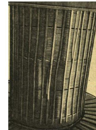
Рис. 2 – Деформированная обмотка трансформатора из-за воздействия токов короткого замыкания
