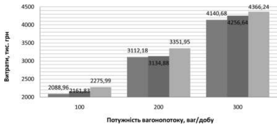
Рис.7 – Сумарні витрати на станції за варіантами технології обміну груп вагонів без зміни поїзного локомотива
