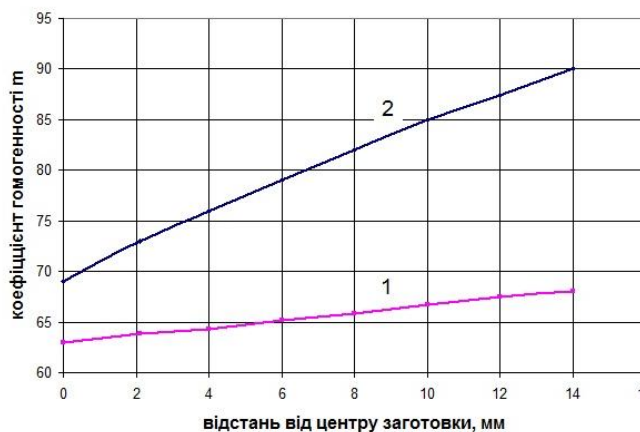
Рис. 6 – Залежність коефіцієнту гомогенності заготовки поздовж радіальної координати після: 1 – без обробки; 2 – першого проходу
