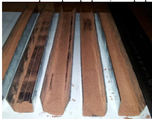
Рис. 3 – Образцы прокатанного порошкового материала в металлической оболочке
