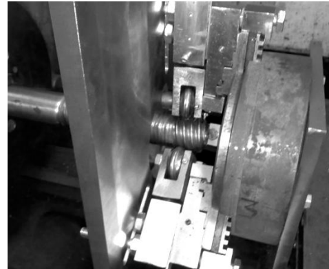
Рис. 18. – Трьохроlikова обkочувальна головка, встановлена на токарно-гвинторізний верстат
