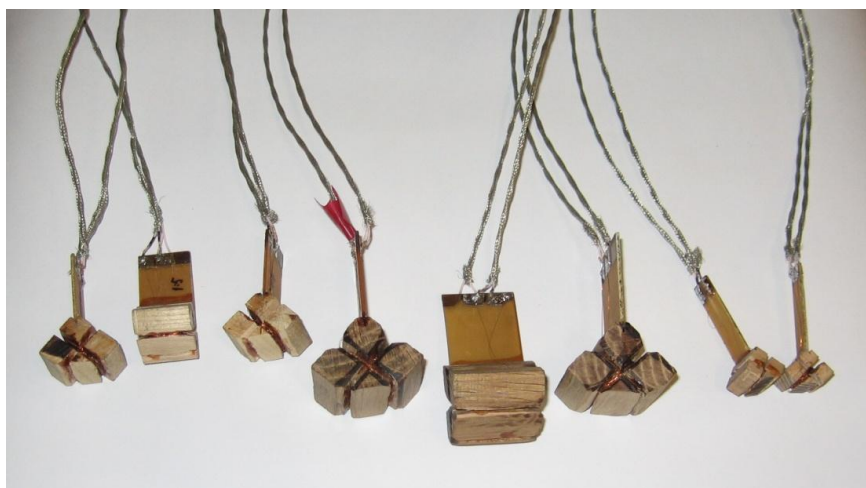
Рис.2. – Модификации компенсированных трансформаторных ВТП для контроля толщины покрытий
