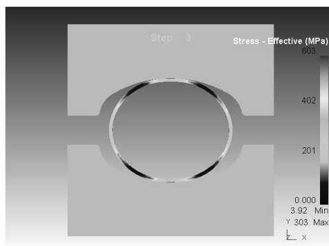
Рис. 3 – Модель схемы формообразования для промежуточного шага нагружения
