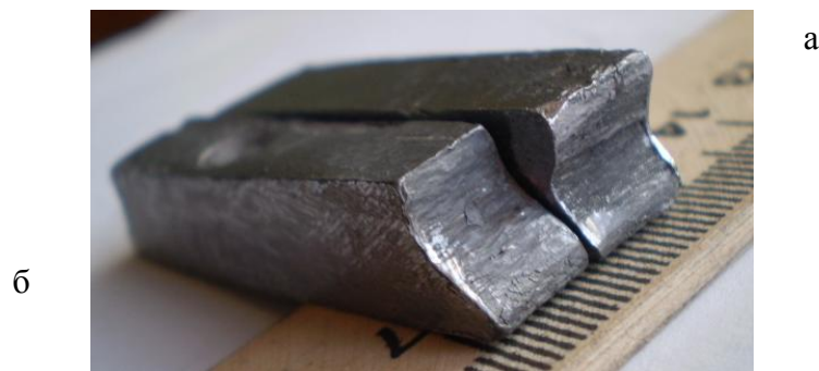
Рис. 3 – Поперечный профиль образцов: а – после симметричной и б – после асимметричной прокатки
