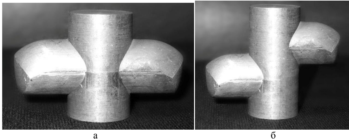
Рис. 5 – Детали, полученные при выдавливании отростков: а – на одной высоте, б – на разной высоте.
