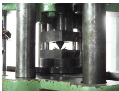
Рис. 4 – Экспериментальная оснастка для изгиба на 120°
