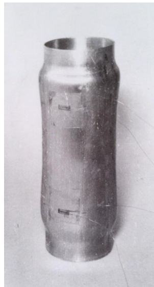
Рис. 2 – Образец после свободной растяжки
