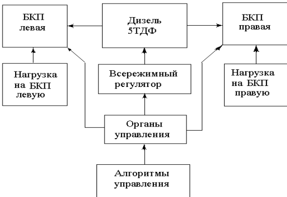
Рисунок 1 – Структурная схема силовой передачи танка Т-64А
