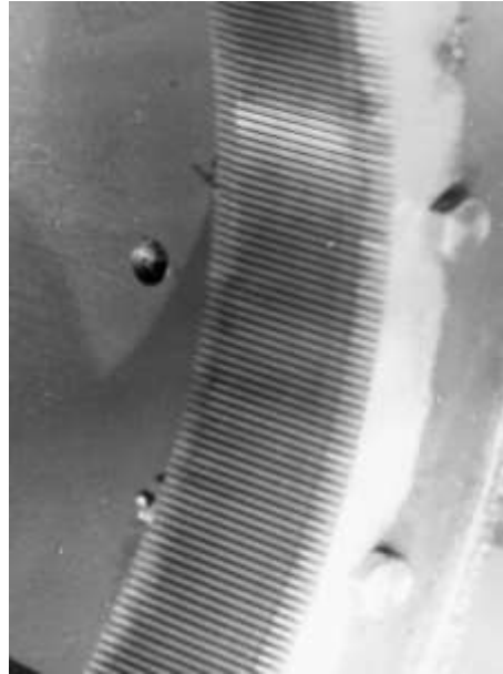
Рисунок 3 – Жесткое колесо волнового редуктора рудоразмольной мельницы МГР5500×7500 с модификацией зубьев: уменьшенной толщиной и коническими срезами периферийных областей по высоте
