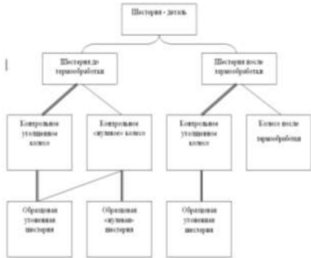
Рисунок 3 – Схема контрольных и образцовых шестерен (колес) для контроля шестерни и колеса прямозубой конической передачи:
