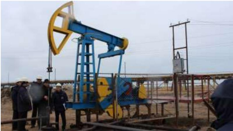
Рисунок 3 – Установка и пуск станка качалки СКД 3-1,5-710 с трехступенчатым двухпоточным пакетным редуктором с  $U_{\Sigma}=64$ , на промысле Пираллахы
