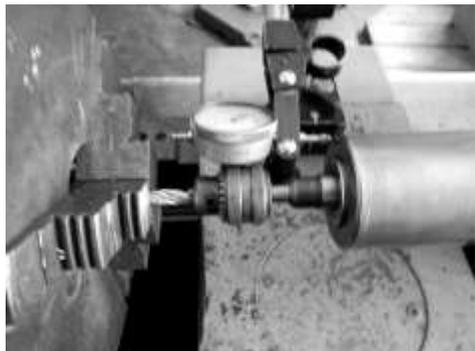
Рисунок 2 – Визначення жорсткості каната при стиску
