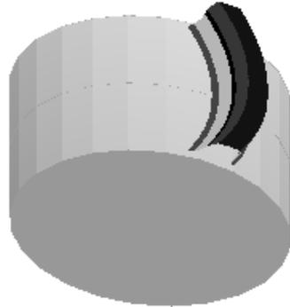
Рисунок 4 – Арочный зуб с циклоидальной формой
