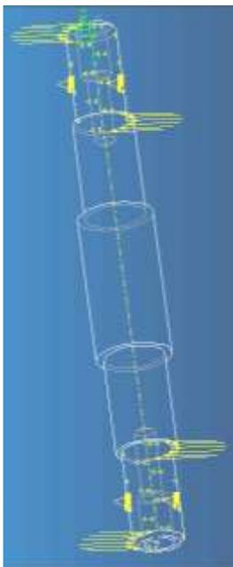
Рисунок 5 – Форма и нагрузка на вал №3
