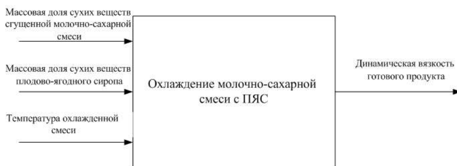
Рис. 1 - Параметрическая схема подсистемы охлаждения молочно-сахарной смеси с ПЯС
