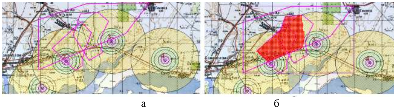
Рис. 5 – Побудова інтегральних зон шуму з урахуванням дії трьох локальних факторів: а – діапазон зон шуму для кожної з чотирьох ВЕУ при початковому розміщенні; б – інтегральна зона шуму
