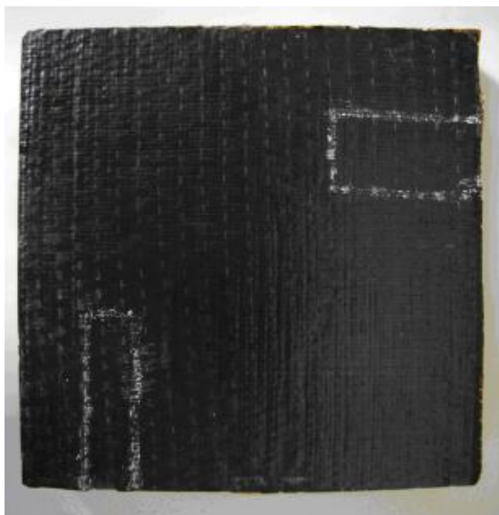
Рис. 3 – Внешний вид исследуемой пластины с обозначенными местами расположения дефектов
