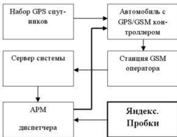
Рис. 3 – Улучшенная схема диспетчерской навигационной системы
