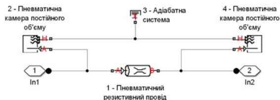
Рисунок 4 – Simscape модель пневмопроводів під маскою (поз. 7, 9, рис. 2)
