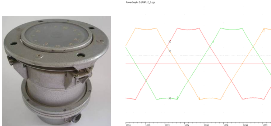
Рисунок 5 – Гіронапівкомпас ГПК-52 та осцилограма запису кута курсу
