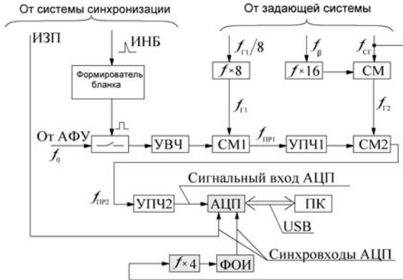
Рис. 3 – Функциональная схема системы приёма, преобразования и обработки сигнала. Здесь АФУ – антенно-фидерное устройство, УВЧ – усилитель высокой частоты; СМ – смеситель; УПЧ – усилитель промежуточной частоты, [f×4] – блок множителя частоты на 4; ФОИ – формирователь импульсов опроса АЦП; ИЗП – импульс запуска передатчика; ИБН – импульс начала бланка.
