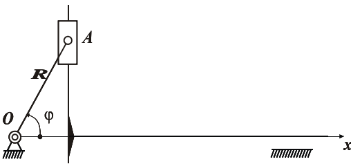
Рисунок 6 - Базовый механизм для кулисного механизма с криволинейным пазом, в котором выходное звено совершает поступательное движение
