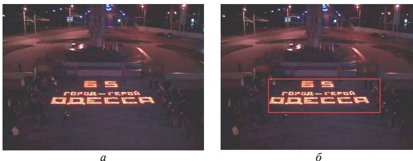
Рис. 2. Пример локализации ТО на изображении с применением предложенного метода: а – исходное изображение; б – результат локализации текстовой области
