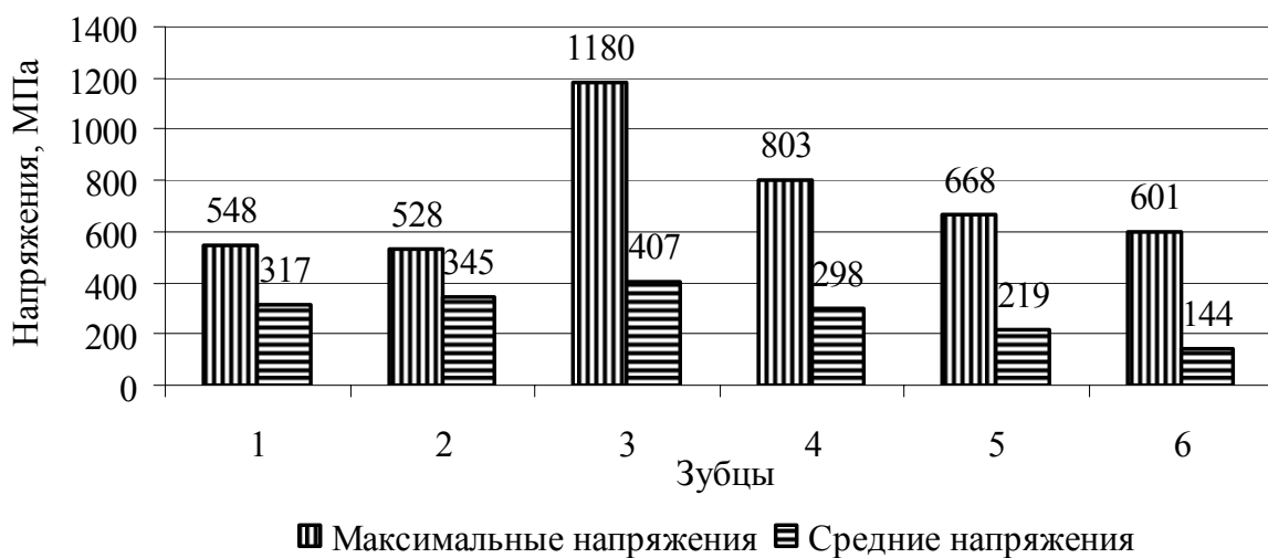
Рис. 7 – Вариант № 3. Распределение напряжений по расчетным сечениям хвостовика
