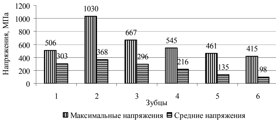
Рис. 6 – Вариант № 2. Распределение напряжений по расчетным сечениям хвостовика
