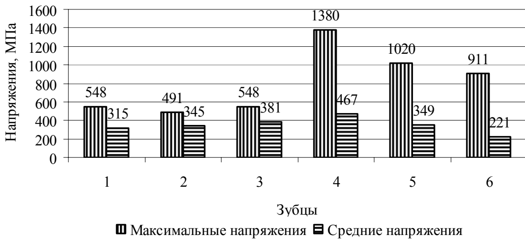
Рис. 8 – Вариант № 4. Распределение напряжений по расчетным сечениям хвостовика
