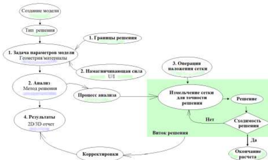
Рис. 5 - Общий алгоритм работы программы для магнитостатического типа задач
