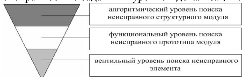
Рис. 1. Модель процесса поиска одиночной неисправности модуля
