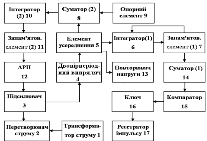
Рис. 1 - Функціональна схема приладу контролю тріщинуватості буримої гірської породи (ПКТБП)
