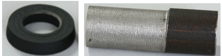
Рис. 3 - Электроды при обработке внешнего контура: а – инструмент; б – заготовка
