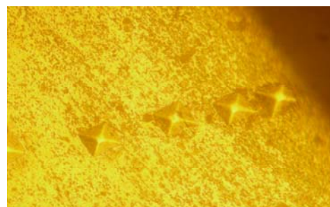
Рис.5 - Структура стали 20Х13 после ермостабилизации. x 500
