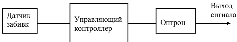
Рис. 3 – Схема контроля наличия материала на транспортной ленте.
