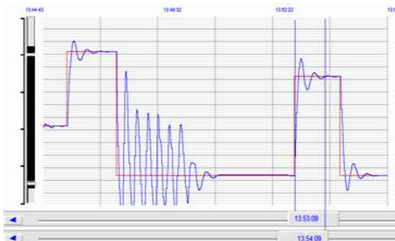
Рис. 2 – Графики переходных процессов в системе управления.
