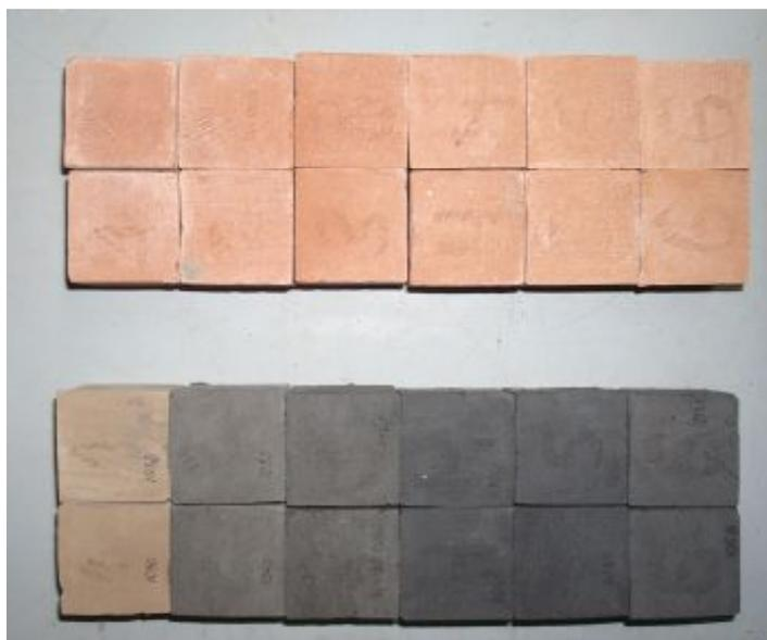
Рис. 7 – Випробувані зразки до і після випалу
