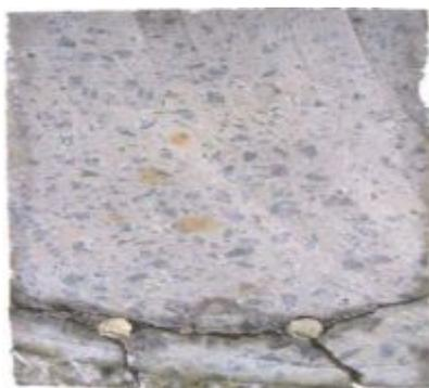
Рис. 4 – Характер разрушения железобетонных конструкций при изгибе
