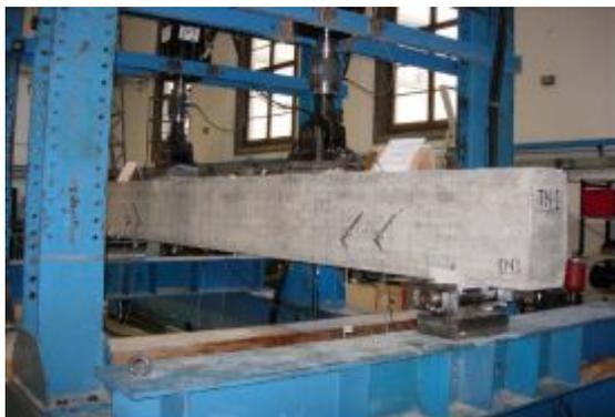
Рис. 3 – Установка для испытания на изгиб железобетонных конструкций
