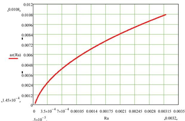
Рис. 3 – Взаимосвязь требуемой шероховатости и толщины среза
