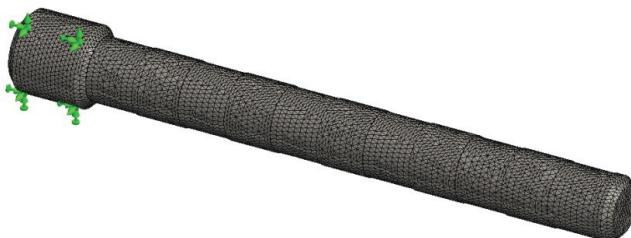
Рис. 6 – Сітка кінцевих елементів
