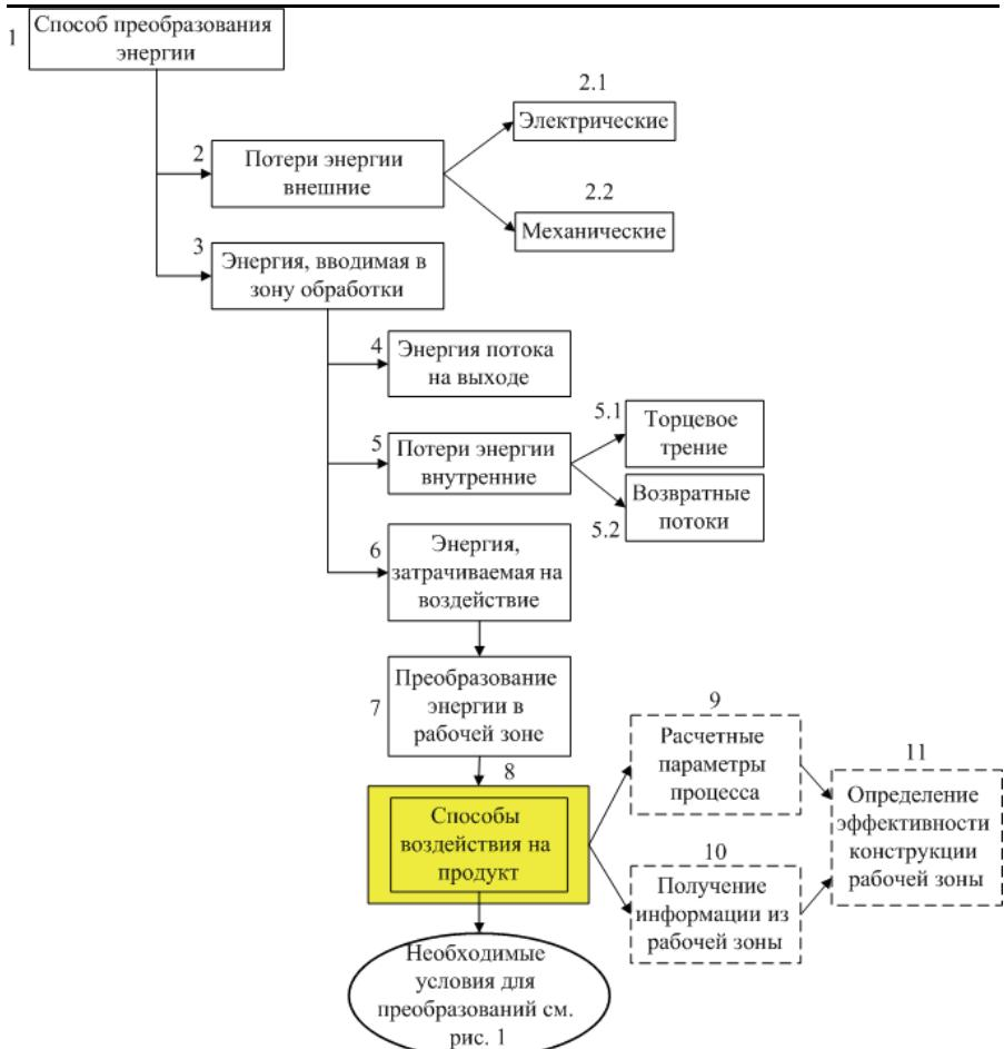
Рис. 2 – Структурна схема взаємосв'язей і взаємовпливів параметрів процесу при дії на робочу середу в РГДА
