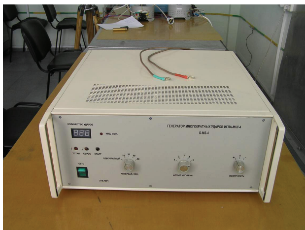
Рисунок 18 – Общий вид генератора ИГЛА-МКУ-4
