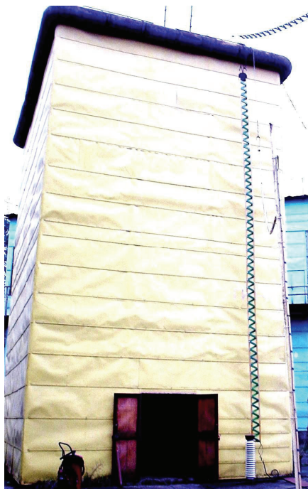
Рисунок 1 – Общий вид генератора ГИН-4 на номинальное напряжение 4 МВ и номинальную запасаемую в его конденсаторах электрическую энергию 1 МДж [5,6]
