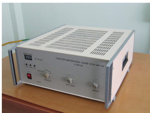
Рисунок 22 – Общий вид генератора ИГЛА-МКУ-5А
