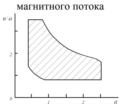
Рис. 2. Диапазон изменения условных показателей  $\beta = \sqrt{S_{\text{эл}} / 2t}$  и  $b/a$  электромагнитов (уточнённые данные для коэрцитиметра КРМ-Ц)
