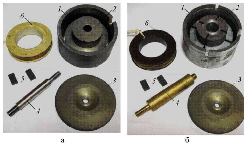
Рис. 1. Основные узлы опытных образцов ЭМП: а – с цельной частью магнитопровода (сердечника); б – с разрезанной частью магнитопровода (сердечника); 1 – корпус; 2 – сердечник; 3 – яркорь; 4 – шток; 5 – постоянные магниты; 6 – катушка.
