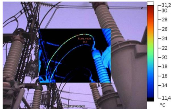
Рис. 6. Результаты тепловизионного контроля контактных соединений на стороне НН трансформатора ПС "Шахта-21" Т-2".
