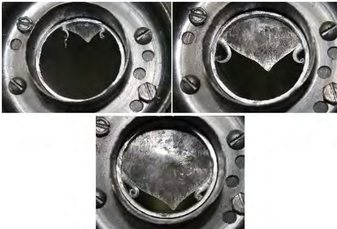
Рис.9. – Процесс внедрения ножа с образованием внутренней стружки-отхода.
