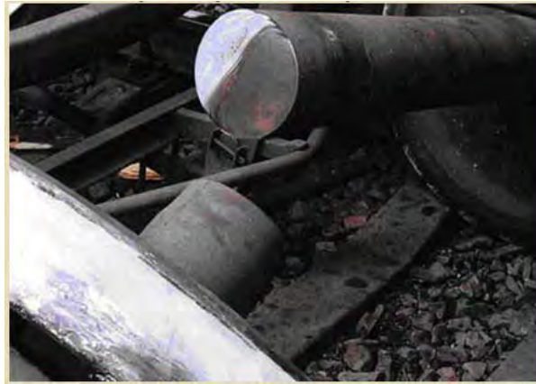
Рис. 1 – Излом оси вагона грузового состава при движении по железной дороге из-за наличия трещины
