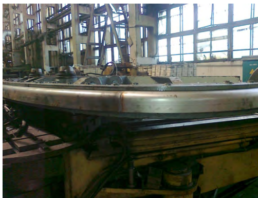
Рис. 1 – Гибочно-растяжной станок в процессе гибки дуги пассажирского вагона
