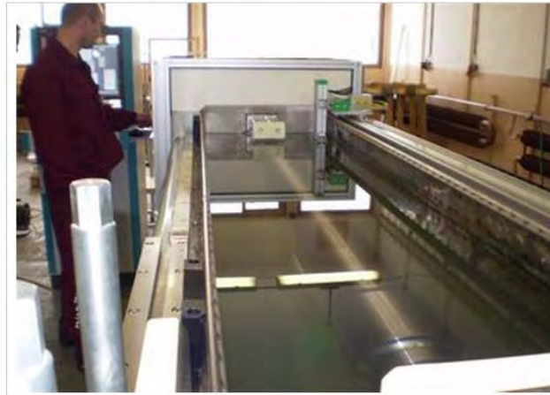
Рис. 3 – Установка для иммерсионного ультразвукового контроля объема металла заготовок железнодорожных осей
