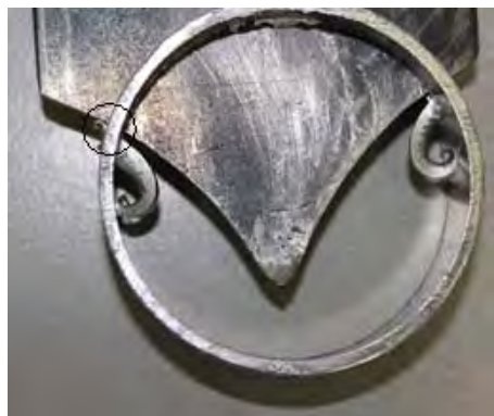
Рис.5. – Отделение стружки-отхода при промежуточном положении ножа.
