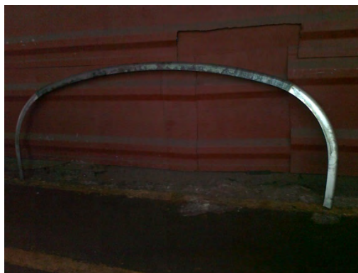
Рис. 3 – Дуга пассажирского вагона из разнородных металлов после гибки с растяжением
