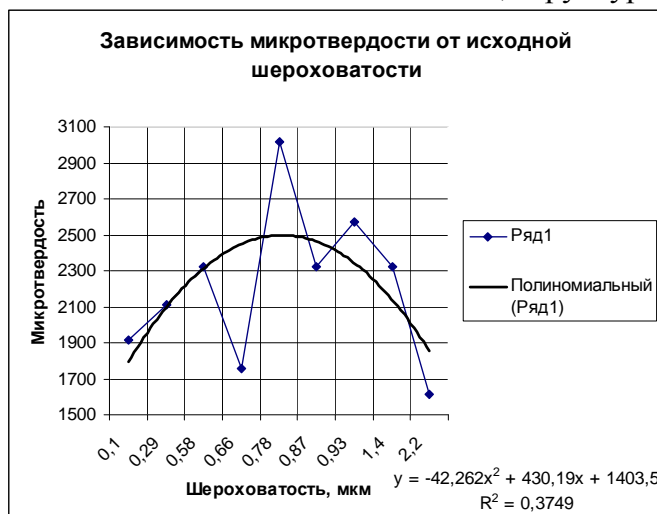
Рис 2. – Зависимость микротвердости от исходной шероховатости обрабатываемой поверхности
