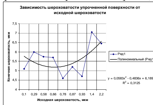
Рис 1. - Зависимость шероховатости упрочненной поверхности от исходной шероховатости
