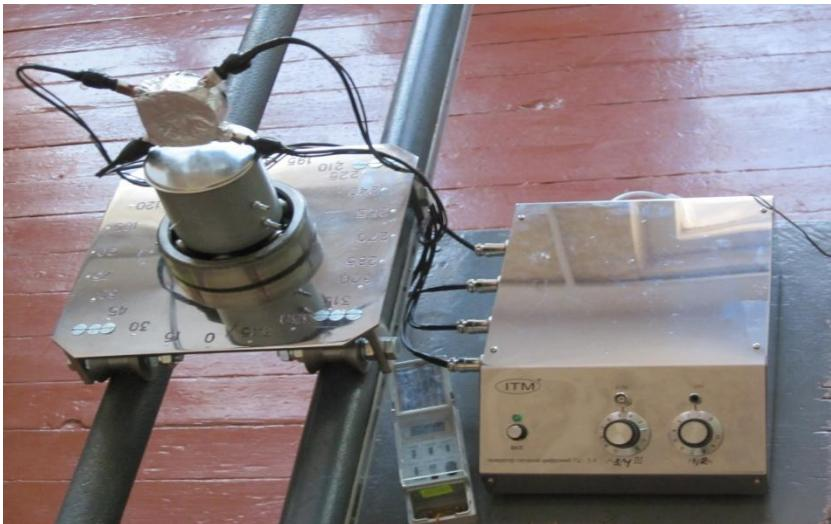
Рис. 1. Чотирьох канальний аналізатор імпульсів з приладом для вимірювання кутів (радіометр ДКС 01 SELVIS застосовується для контролю потужності експозиційної дози  $\gamma$ -випромінювання).
