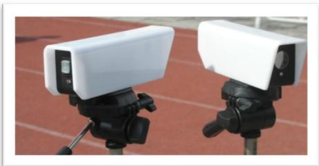
Рис. 1. Однолучевой оптический створ. ИК-излучатель и приемник разнесены.
