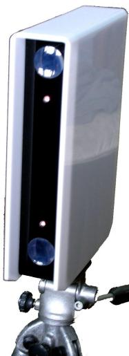
Рис.3. Двухлучевой оптический створ
