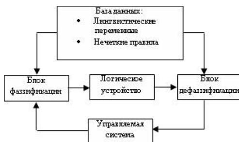
Рис. 8. Блок схема МК реализующего нечеткую логику
