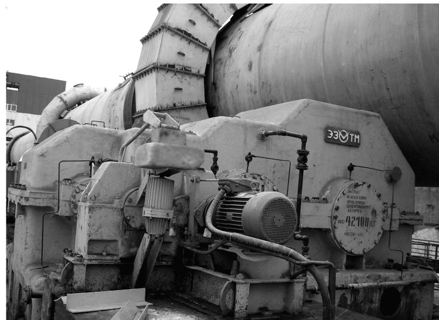
Рисунок 2 – Привод вращающейся печи Ø4,5×170м с редуктором ЦТ-3230
