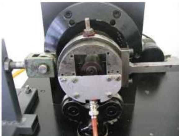
Рисунок 1 – Испытательный скользящий узел
