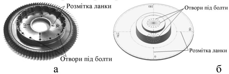
Рис. 2. Розмітка ланки ротора КВТ ГТД з отворами під болти: а – фотографія; б – 3D модель
