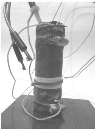
Рис. 4. Макет полого ферромагнитного ротора для определения электромагнитных параметров.
