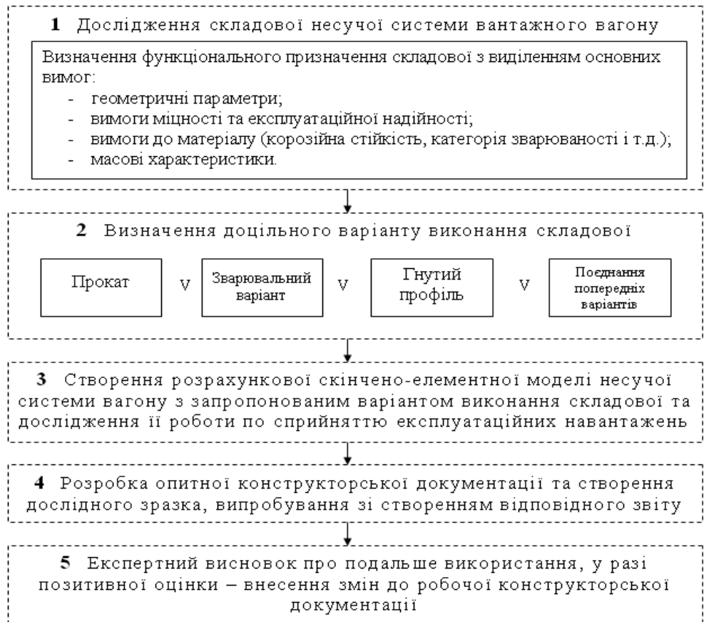
Рис. Схематичне зображення методики впровадження різних профілів в якості складових елементів несучих систем вантажних вагонів
