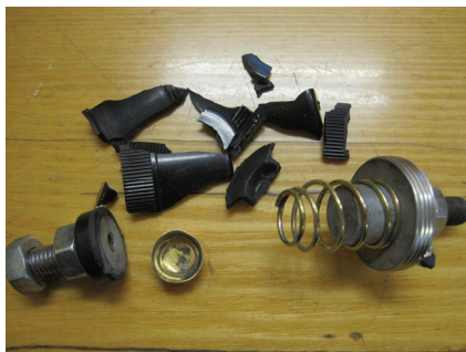
Рисунок 5 – Внешний вид фрагментов сработавшего отделителя
