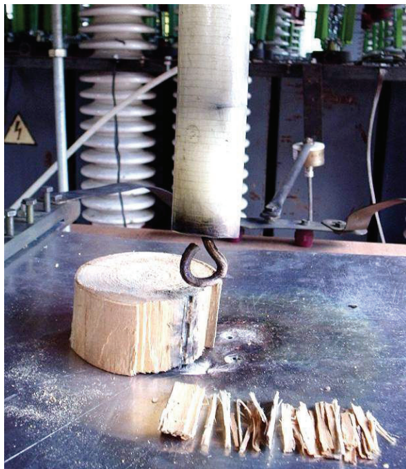
Рисунок 6 – Внешний вид опытного образца «мертвой» древесины сосны после его электродинамического испытания в сильноточной разрядной цепи генератора импульсной А- компоненты тока искусственной линейной молнии ( U_{3A} \approx -7 кВ и I_{mA} \approx -41,4 кА)
