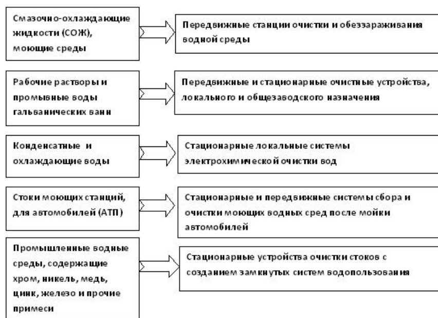
Рис. Варианты технологических схем очистки промышленных водных сред (разработки кафедры ОТиОС НТУ «ХПИ»)
