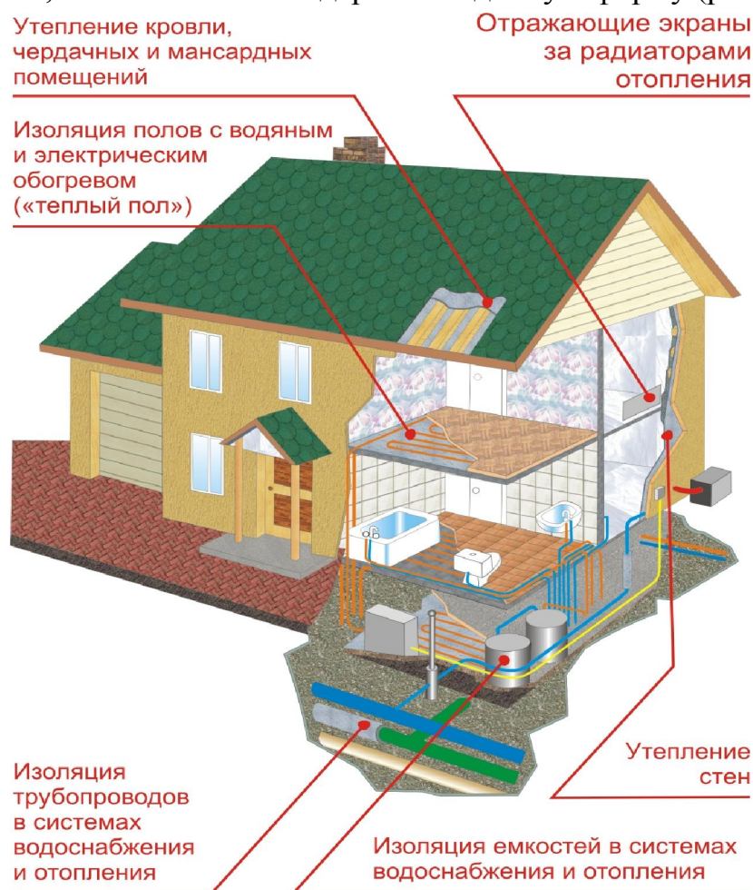
Рис. 2. Пример использования вспененного полиэтилена на объектах строительства
