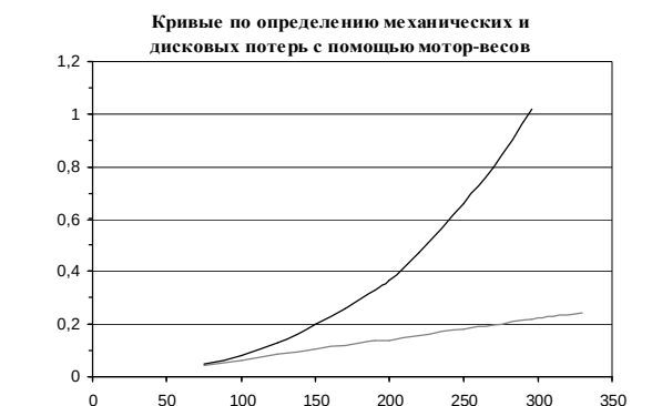
Рис.1 - Кривые по определению механических и дисковых потерь с помощью мотор-весов
