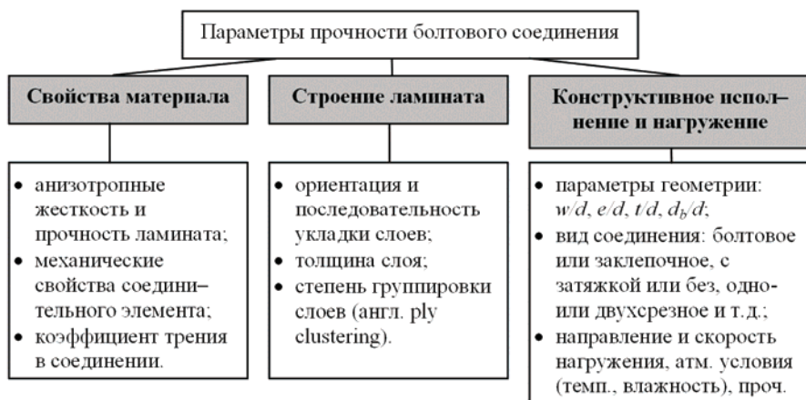
Рисунок 7 – Основные параметры прочности болтовых соединений в ламинатах
