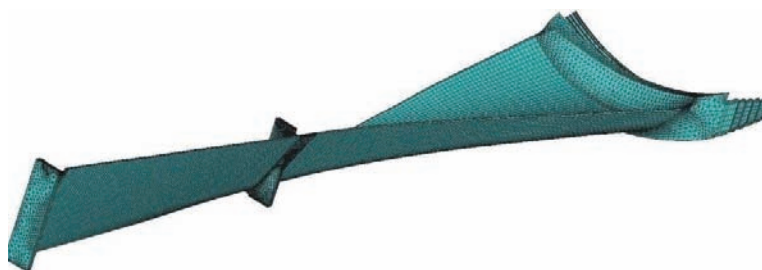
Рисунок 2 – Конечно-элементная модель лопатки
