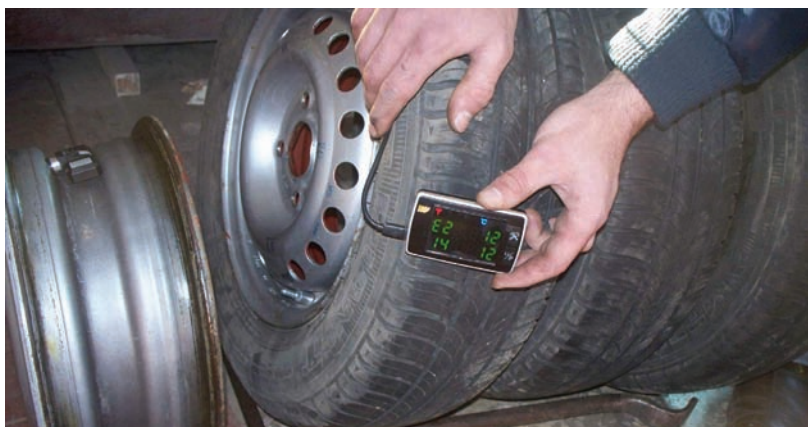
Рисунок 2 – Тестовый замер температуры в собранных шинах
