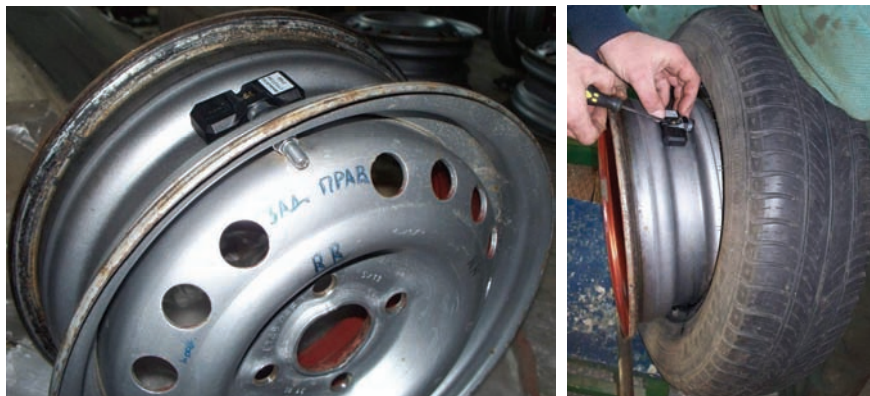
Рисунок 1 – Установка датчика для мониторинга температуры в шинах
