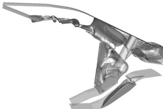
Рис. 2. Изоповерхности нулевой осевой скорости, рассчитанные при 3D «трубном» профиле параметров потока на входе в диффузор
