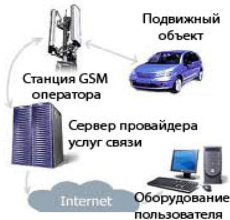
Рисунок 1– Передача данных с подвижного объекта с использованием GSM-каналов связи
