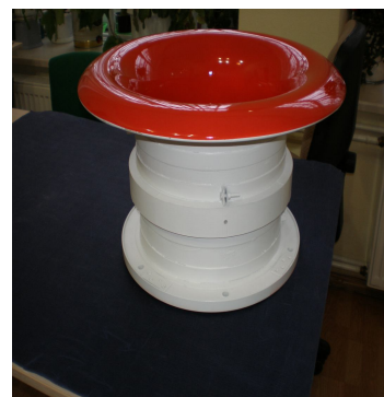
Рис.6 Функциональные изделия из полиамидного порошка «выращенное» на установке Vanguard HS, подготовленное к приемке
