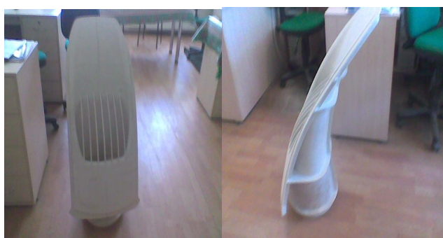
Рис.3 Функциональное изделие «выращенное» на установке Vanguard HS
