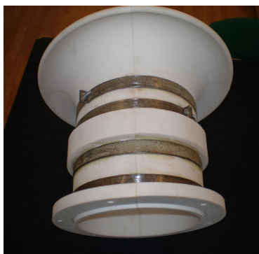
Рис.5 Функциональные изделия из полиамидного порошка «выращенное» на установке Vanguard HS, в сборе
