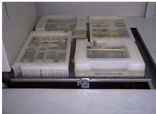
Рис. 7 Промодели для пресс-формы на изделие «Бачок омывательный»
