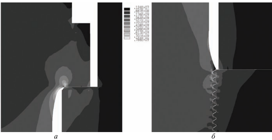
Рисунок 3 – Распределение эквивалентных напряжений по Мизесу на галтелях (болт М110х4): а – под головкой; б – возле резьбы
