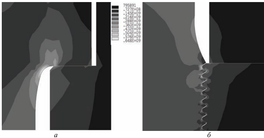
Рисунок 5 – Распределение эквивалентных напряжений Мизеса по галтелям, Па (реальная модель М100х4): a – под головкой; б – возле резьбы.
