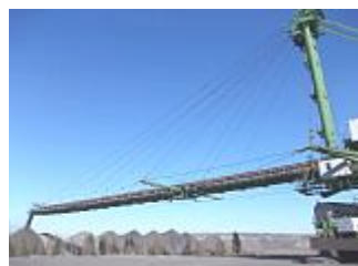
Рис. 3. Отвальная консоль, пилон и жесткие горизонтальные тяги (ОШС черт.152.00.00.000)
