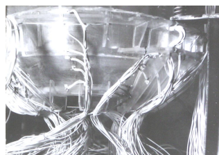
Рис. 22. Установка тензорезисторов в зоне крепления подвески корпуса к опорному кольцу (вариант Б)
