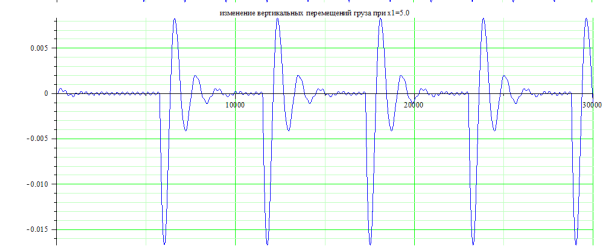
Рис. 30. Динамический процесс в одномассовой системе при увеличенном коэффициенте вязкого трения в 10 раз: а – \alpha_1 = 0,5 ; б – \alpha_1 = 1,0 ; в – \alpha_1 = 1,5 ; г – \alpha_1 = 2,0 ; д – \alpha_1 = 5,0
