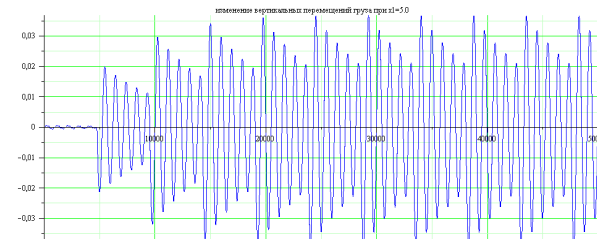
Рис. 23. Динамический процесс в одномассовой системе при: а – \alpha_1 = 0,5 + 1\% ; б – \alpha_1 = 1,0 + 1\% ; в – \alpha_1 = 1,5 + 1\% ; г – \alpha_1 = 2,0 + 10\% ; д – \alpha_1 = 5,0 + 1\%
