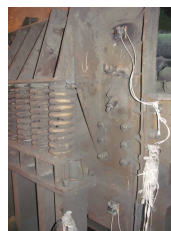
Рис. 2. Схема расположения датчиков на корпусе выбивной машины и способы их крепления
