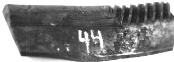
Рис. 5. Недокат, полученный при опробовании нового способа прокатки
