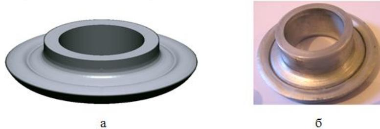
Рис. 5. Сравнение дефектообразования при радиальном выдавливании фланца между моделированием методом конечных элементов в программном комплексе QForm 2D (а), и экспериментом (б)
