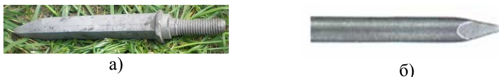
Рис. 2. Зуб бороны (а) и зубило пикообразное (б)
