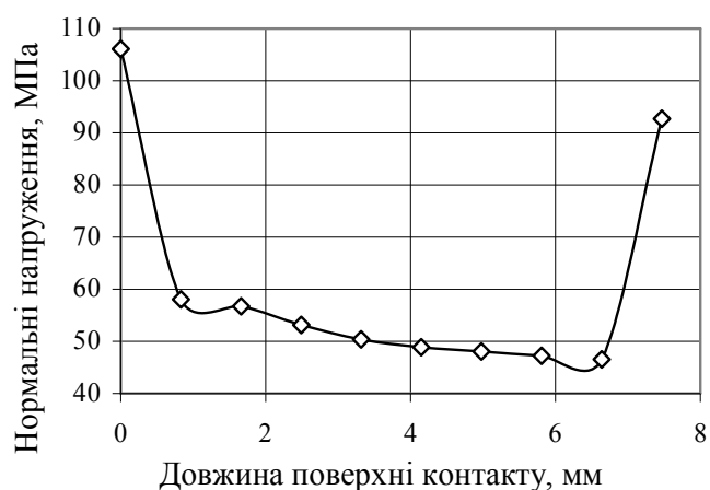
Рис. 10. Розподіл нормальних напружень на поверхні заготовки, яка контактує з пуансоном
