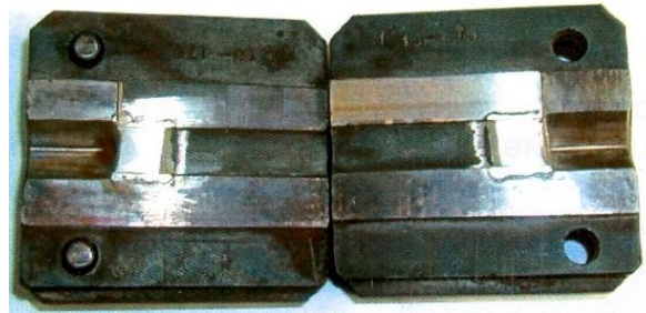
Рис. 2 Роз'ємні напівматриці для пресування заготовок робочих лопаток
