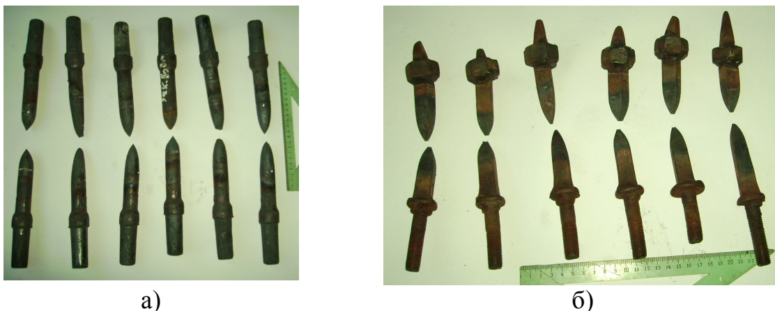
Рис. 7. Заготовки круглого поперечного сечения («зубило») (а) и квадратного поперечного сечения («зуб бороны») (б), разделенные при различных длинах участков нагрева
