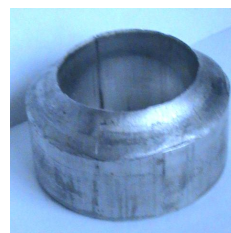
Рис. 4. Дефект утяжина, полученный на верхнем (а) и нижнем (б) торцах втулки
