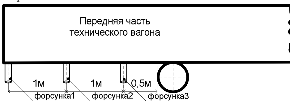
Рис.2. Схема установки плазменных форсунок на техническом вагоне.
