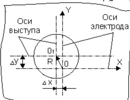
Рис. 2. Отклонение центра наплавленного выступа
