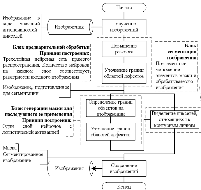
Рис. 3. Схема нейросетевой структуры для сегментации низкоконтрастного изображения
